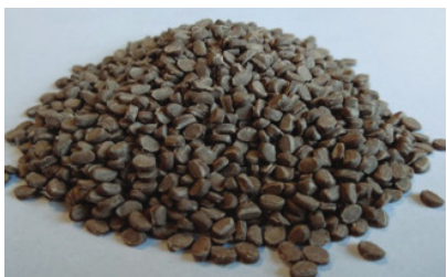
Mineraalne graanul, mis sisaldab põlevkivituhka ja polümeere
